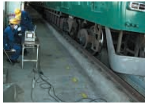
輪重測定装置
